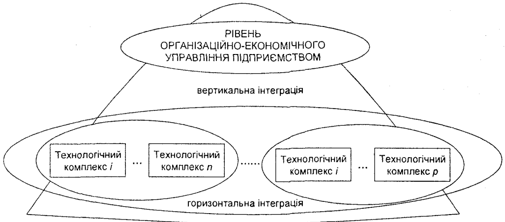
Рис. 1.1. Напрями інтеграції в автоматизованих системах управління
