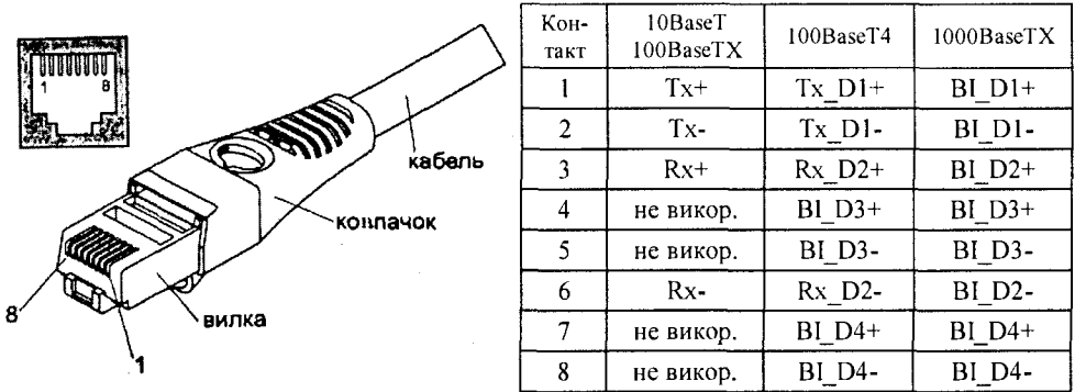
Рис. 10.2. Призначення контактів роз'єму RJ-45
